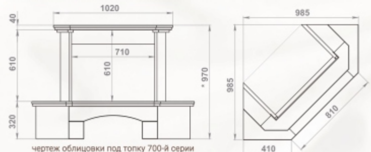
чертеж облицовки под топку 700-й серии
